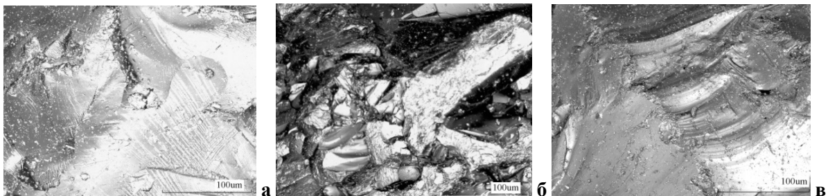
Рисунок 6. Микрофото поверхности зерен кварца после ЭГД дробления: а – Хизоваара; б – Степаново озеро; в – Куйваниеми
