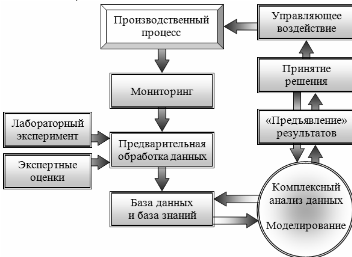
Рисунок. Обобщенная схема использования средств информационной поддержки в управлении процессами переработки минерального сырья
