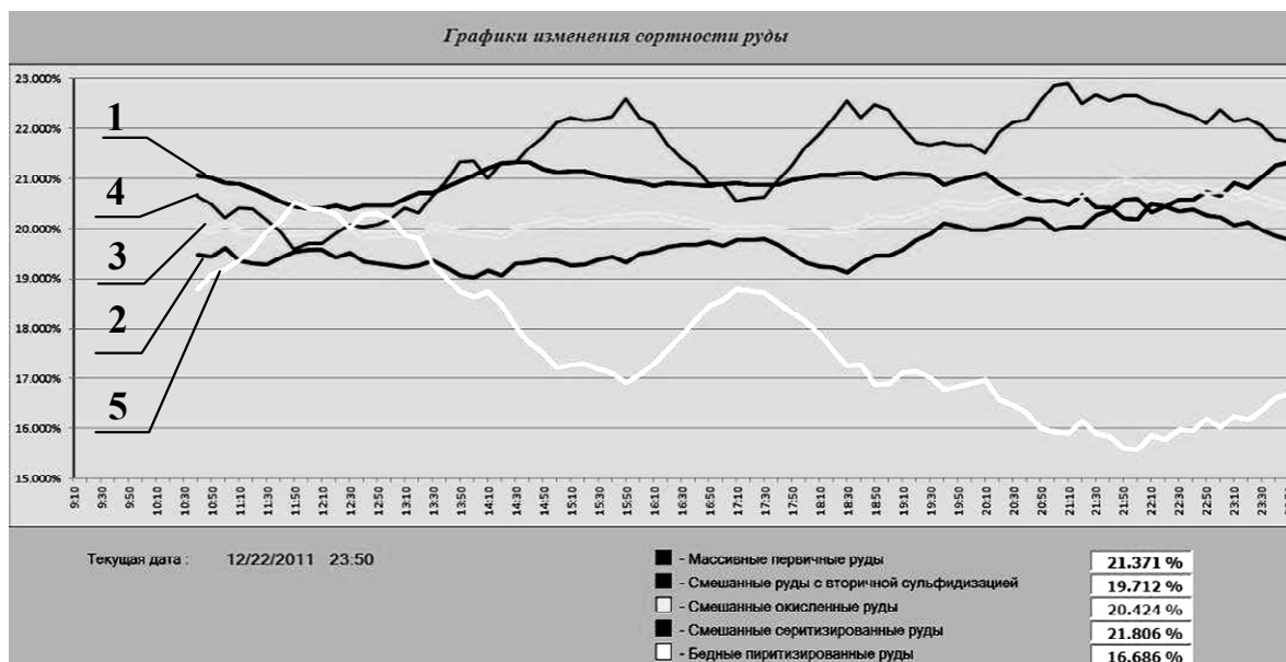
Рисунок 3. Временная зависимость состава руды текущей добычи: 1 - массивные первичные руды; 2 - смешанные руды с вторичной сульфидизацией; 3 – смешанные окисленные руды; 4 – смешанные серитизированные руды; 5 - бедные пиритизированные руды
