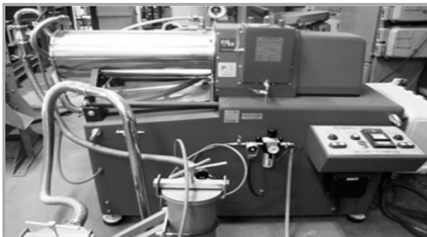
Рисунок 1. Общий вид бисерной мельницы ультратонкого измельчения Supermill, модель ЕНР
